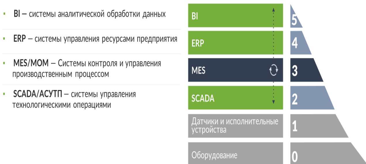
Рис.5. Уровни автоматизация АСУ ТП и АСУ П
