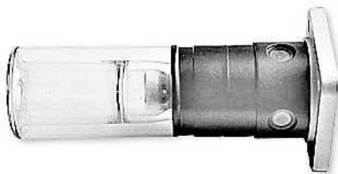
Рис. 25. Рентгеновская трубка БСВ-43 для структурного анализа
